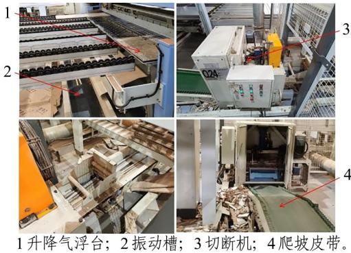
图1 废料处理设备结构
